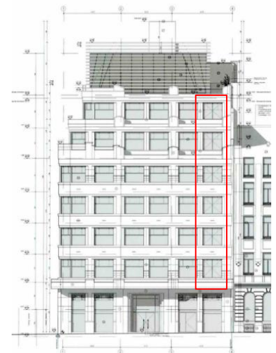
Ontwerp gevel Koningsstraat – in het rood de geplande 'verhuisramen' – plan uit het aanvraagdossier
